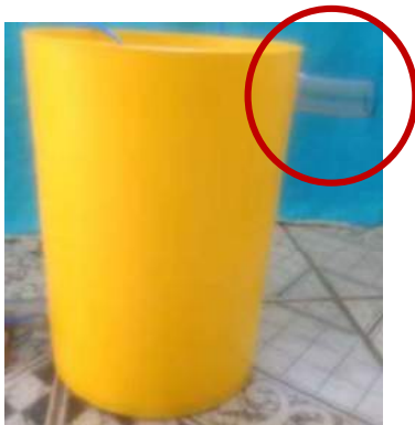
Figura 5: balde de 15L que substitui o reservatório de vidro do experimento original e representação do ladrão onde manterá o nível constante.
